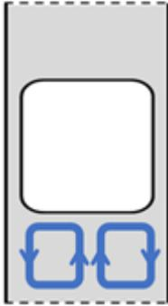
Figura 1. Configuración de una celda unitaria conteniendo una burbuja de Taylor con un vórtice por detrás.
