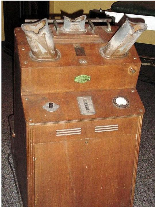
*Figura 6. Aparato de rayos X utilizado en zapaterías para comprobar el ajuste de los zapatos*
